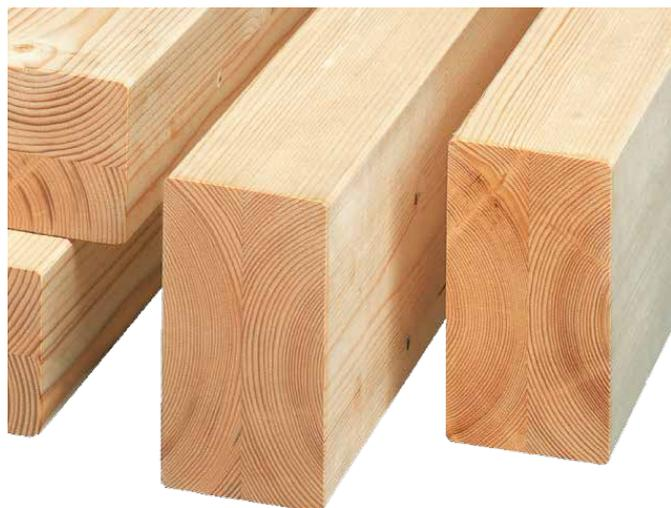
Élément de structure en bois constitué de 2 à 4 plis collés entre eux. Les épaisseurs des plis varient de 45 à 85 mm maximum.
